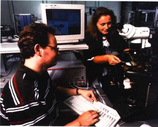
Bild 2: An diesem Meßplatz im Aachener Demonstrationszentrum aixACCT (Advanced Ceramic Coating Technologies) werden ferroelektrische Dünnschichtkondensatoren und Speicherzellen auf ihre Funktionsfähigkeit getestet. (Foto: P. Winandy)
